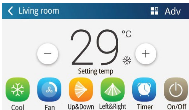
Fig.5.1 Pagina del controllo dell'unità interna singola
