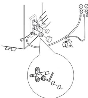
Les travaux de raccordements frigorifiques, les contrôles d'étanchéité, le tirage au vide ainsi que les appoints de gaz et contrôles de bon fonctionnement de l'appareil, doivent être effectués dans les règles de l'art et conformément à la norme EN 378, par un professionnel qualifié et titulaire d'une attestation de capacité à manipuler les fluides frigorigènes.
