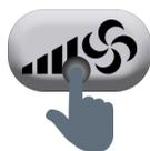
Ce bouton fait varier la vitesse de ventilation sur 5 niveau de puissance ou la positionne en « Auto ». Dans ce cas, le climatiseur va réguler automatiquement la vitesse de soufflage.
