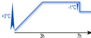
Si la température souhaitée est comprise entre **24 & 27°C**, la température va monter de 2°C sur 2h puis se stabiliser pendant 5h. Elle va ensuite diminuer de 1°C puis se stabiliser.
