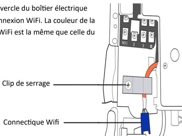
**Etape 3 :** Retirez le clip de serrage pour extraire le câble de connexion WiFi du boîtier électrique. Connectez-le avec la connectique du module WiFi.
