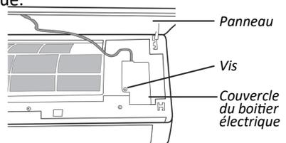
**Etape 2 :** Ouvrez le couvercle du boîtier électrique pour repérer le câble de connexion WiFi. La couleur de la connectique de connexion WiFi est la même que celle du module WiFi, bleue.
