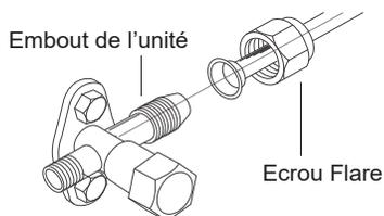
d. Serrez l'écrou-évasé avec une clé dynamométrique en vous référant au tableau ci-dessous :
