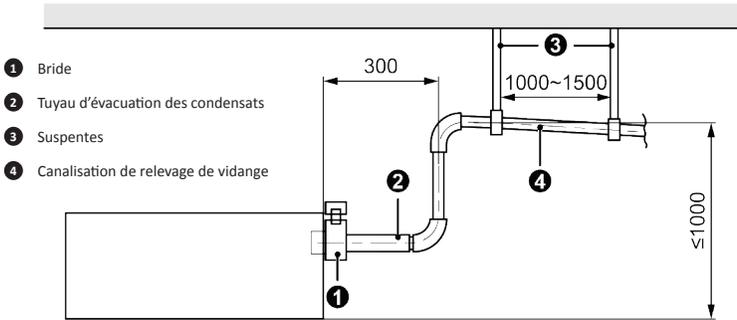
La hauteur verticale de la partie souple du tuyau d'évacuation des condensats doit être inférieure ou égale à 75 mm afin que le port de vidange n'ait pas besoin de résister à une force supplémentaire.
