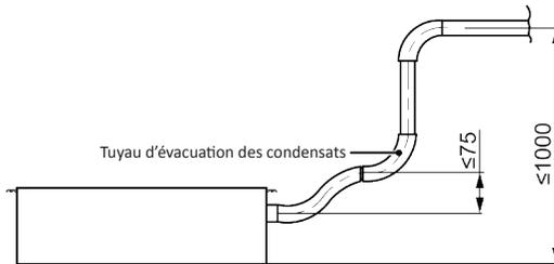
Si plusieurs tuyaux d'évacuation des condensats sont utilisés, leur pose doit s'effectuer comme indiqué dans la figure ci-dessous.
