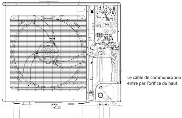
Les câbles d'alimentation des unités intérieure et extérieure entrent par l'orifice du bas
