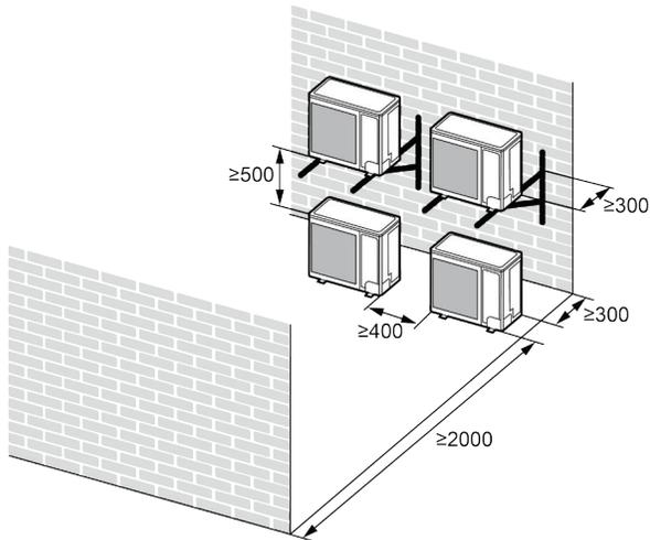
(2) Schéma de l'espace et de l'emplacement d'installation de l'unité intérieure (mise en garde : afin d'optimiser les performances de l'unité intérieure, veillez à ce que son espace d'installation respecte les dimensions d'installation suivantes).
