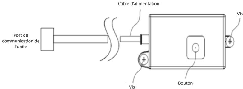
Lorsque le Module WiFi est associé à l'application Heiwa Clim via le réseau local, il peut exécuter les fonctions de surveillance à distance, gestion de programmes, réglage de température et autres fonctions du climatiseur.
