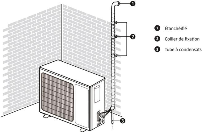
(2) Si l'unité extérieure se trouve au-dessus de l'unité intérieure, disposez la canalisation conformément au schéma suivant.
