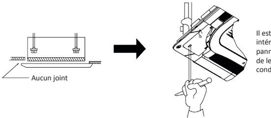
Il est possible d'ajuster la hauteur de l'unité intérieure via les orifices des coins du panneau avant, à condition que le niveau de levage de l'unité intérieure et du tube à condensats n'en soit pas affecté.
