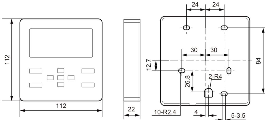
Fig.21 : Dimensions de la télécommande filaire
