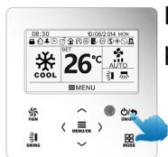
Lorsque le télécommande filaire est sur la page principale, appuyez sur le bouton ON/OFF pour allumer l'unité. Ré-appuyez sur le bouton ON/OFF pour éteindre l'unité. Les interfaces des états marche/arrêt sont indiquées à la Fig. 4 et 5.
