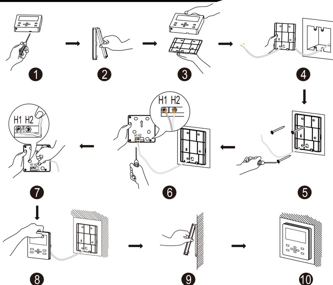
Fig.23 : Schéma d'installation de la télécommande filaire
