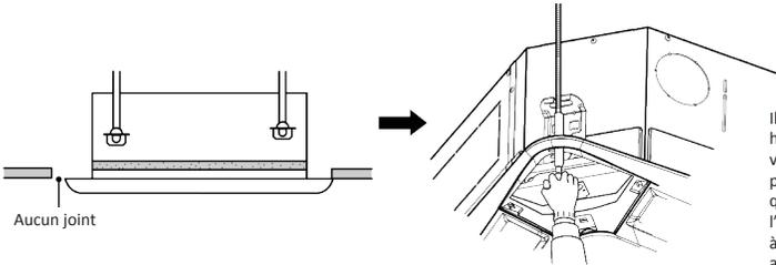
Il est possible d'ajuster la hauteur de l'unité intérieure via les orifices des coins du panneau avant, à condition que le niveau de levage de l'unité intérieure et du tube à condensats n'en soit pas affecté.
