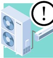
L'UE et l'UI doivent rester aussi proches que possible afin de réduire la longueur du tuyau de réfrigérant et les coudes.
