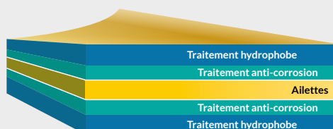
Double traitement des ailettes de l'échangeur
