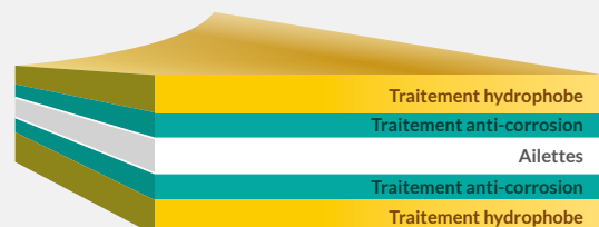
Double traitement des ailettes de l'échangeur
