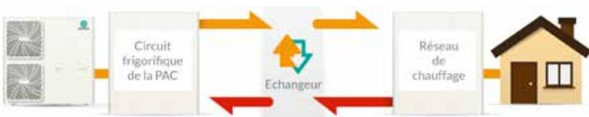
En mode chaud, la PAC Air/Eau va capter les calories dans l'air extérieur et les échanger avec l'intérieur au travers d'une boucle d'eau via un plancher chauffant des radiateurs et/ou ventilo-convecteurs.
